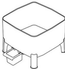
**3** 液肥収集トレイ内に1つの作業トレイをのせます。水でふやかしたココナッツブロックの3/4をこの作業トレイに追加します。
